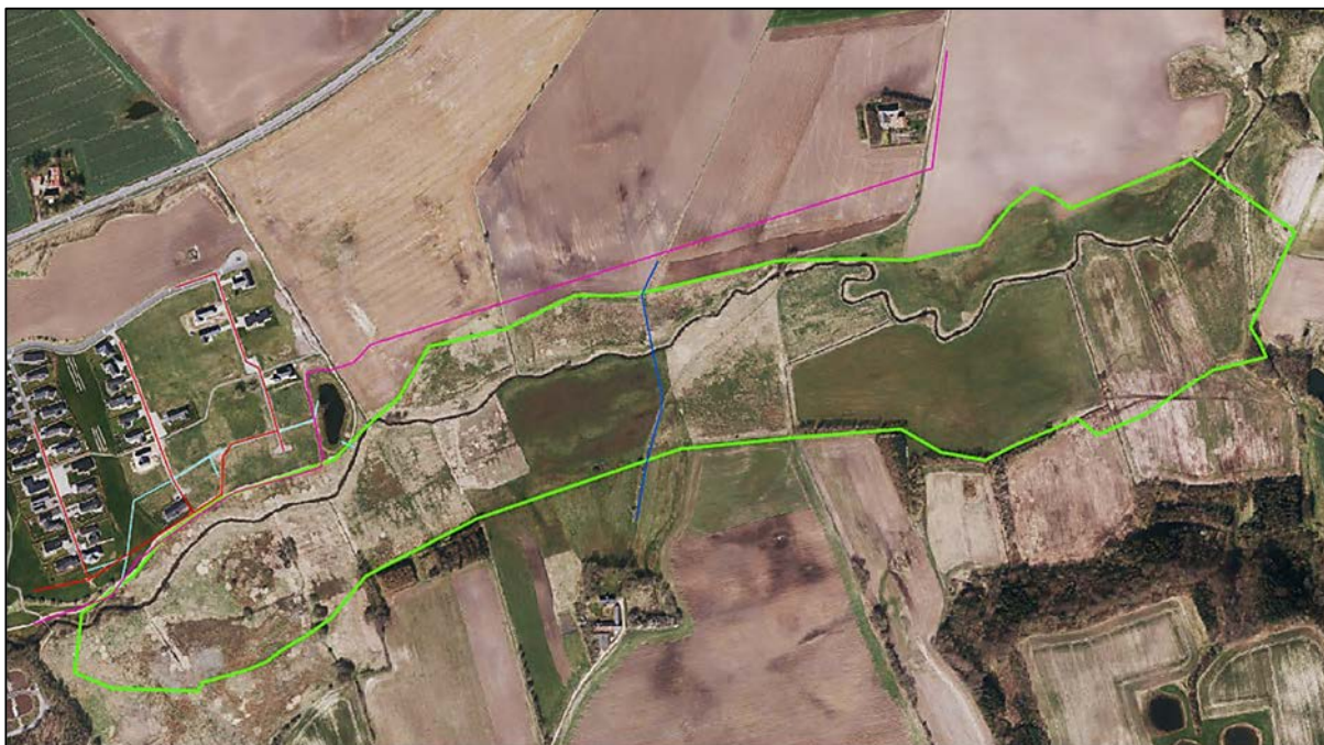
Figur 4-11 Ledninger (LER) i undersøgelsesområdet. Lyserød er spildevandsledning med tryk, blå er et 10kv el-kabel.
